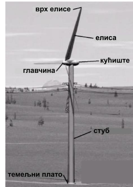
Слика 3 – Основни елементи ветрогенератора (Из докумената Међународне финансијске корпорације-IFC)
