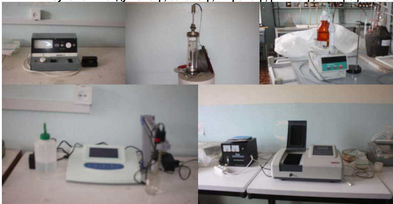
Рисунок 34 - Кондуктометр, батометр, титрометр, рН - метр, спектрофотометр.
