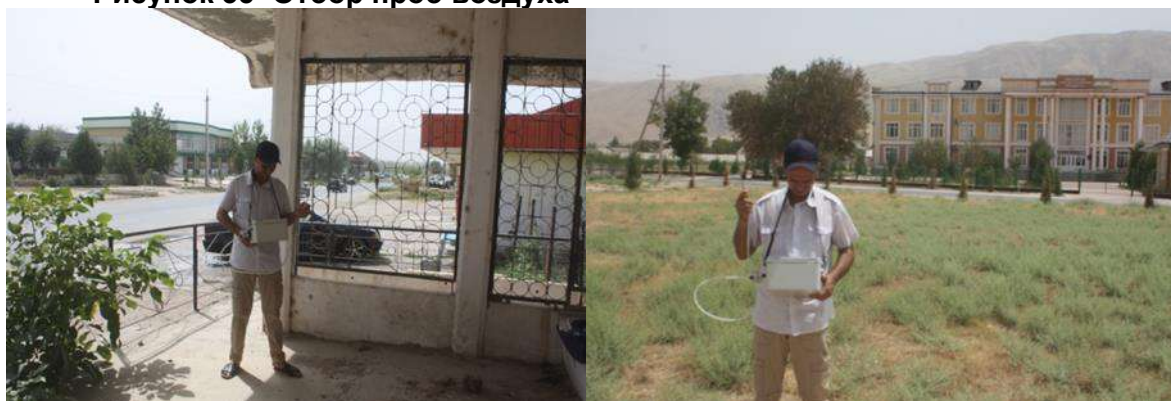
Рисунок 35- Отбор проб воздуха
