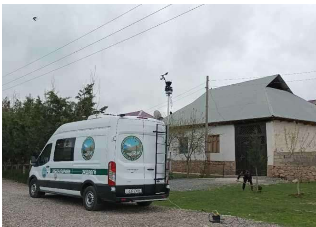
Фото 6. Измерение параметров качества воздуха в селе И. Шарипов
