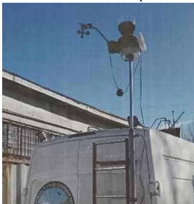
Фото 4. Установка для измерения климатических условий региона (скорость ветра, атмосферное давление, влажность, направление ветра, температура)
