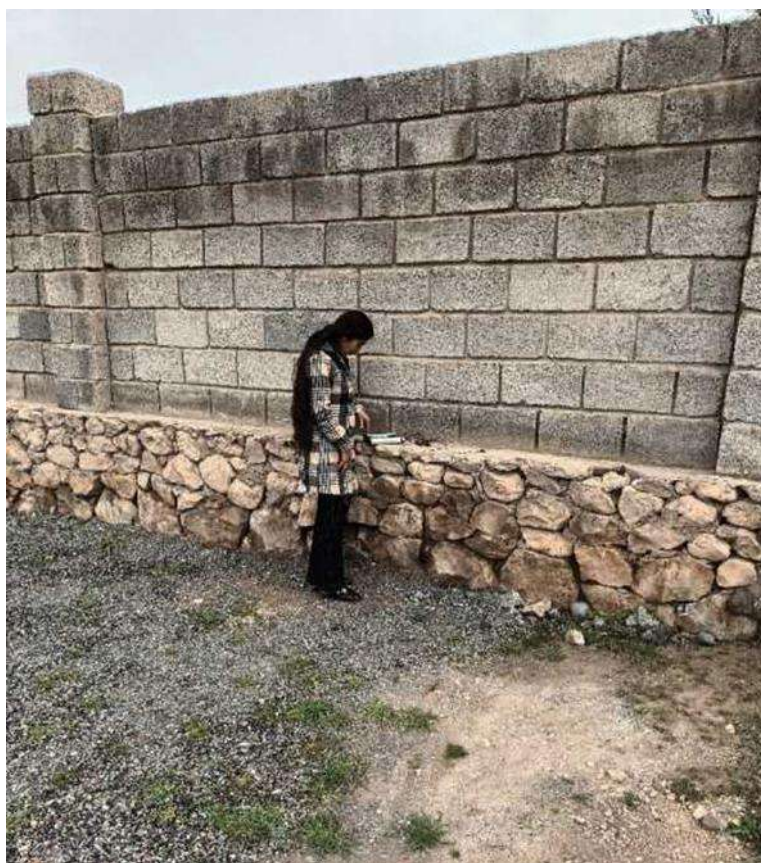
Фото 12. Измерение уровня вибрации у забора жилого дома здания в точке мониторинга № 5
