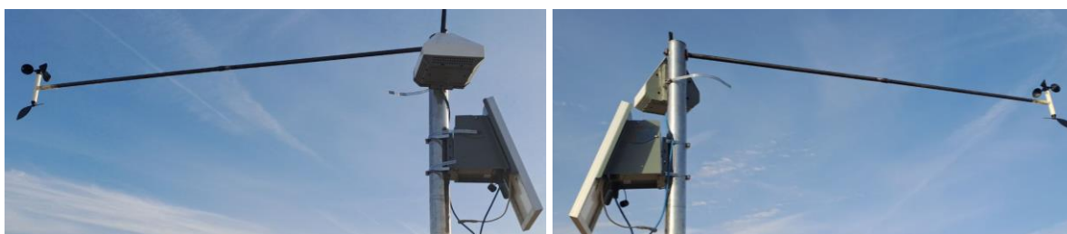
Рисунок 95: Система мониторинга воздуха на AN 3
