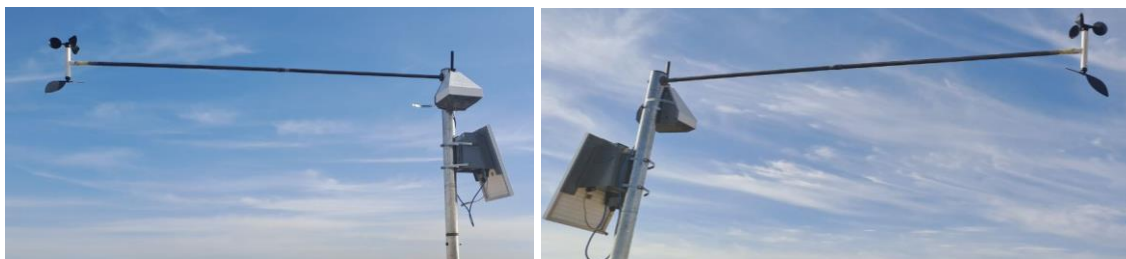
Рисунок 92: Система мониторинга воздуха на AN 1
