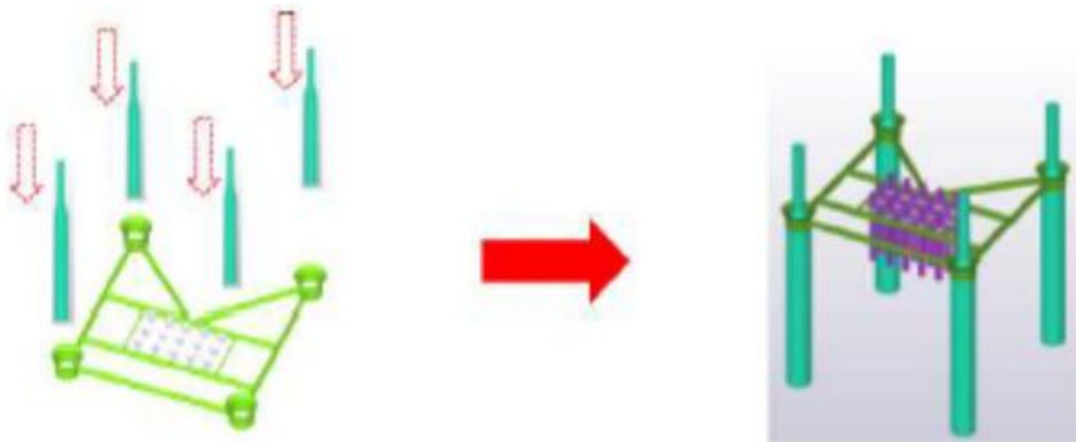
Σχήμα 3-17: Έμψη των πυλώνων δια μέσω του πλαισίου / οδηγού
