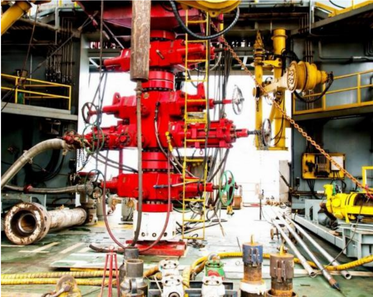
Σχήμα 3-25: Τυπικό σύστημα BOP (ξηρό) σε γεωτρήπανο τύπου Jack up
