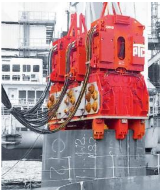
Σχήμα 3-23: Παλμικός μηχανισμός οδήγησης κατά τη λειτουργία του.
