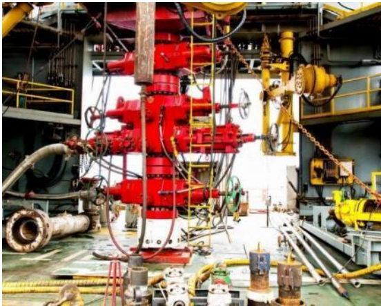
Σχήμα 2-52: Τυπικός μηχανισμός BOP σε αυτοανυψούμενη εξέδρα (Jack up Rig)
