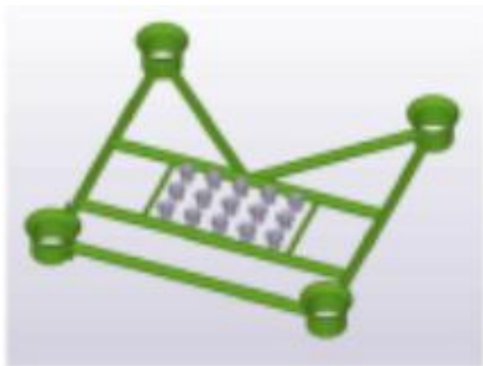
Σχήμα 3–15: Πλαίσιο / οδηγός των πυλώνων και των προστατευτικών αγωγών των γεωτρήσεων
