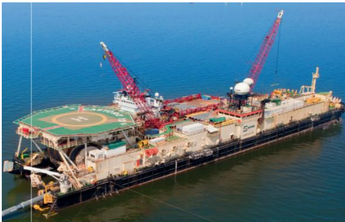
Σχήμα 2-42: Τυπικό σκάφος τοποθέτησης αγωγού (μέθοδος S lay)
