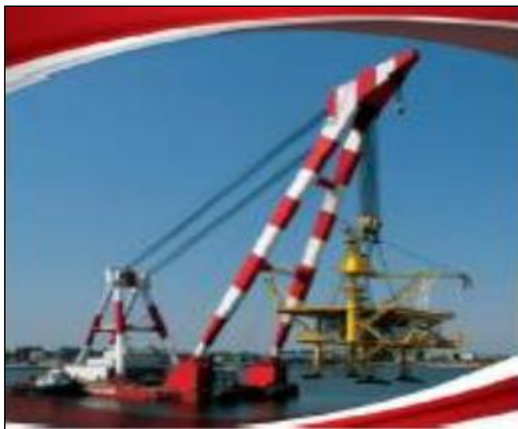
Σχήμα 3-18: Πλωτός γερανός αρθρωτής τριγωνικής μπούμας
