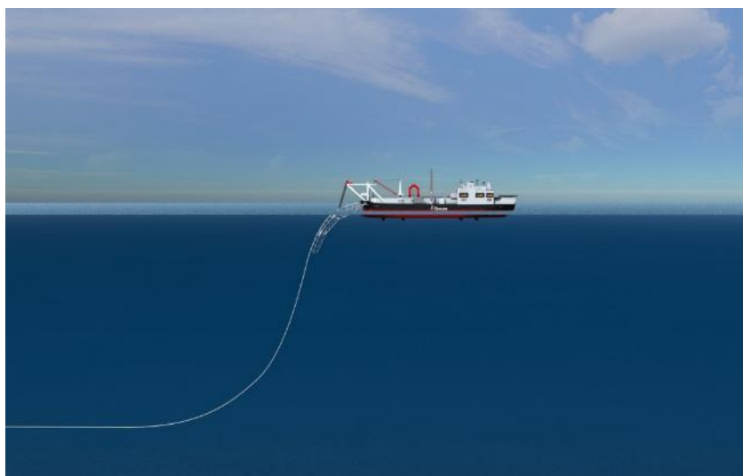
Σχήμα 2-43: Μέθοδος S-Lay
