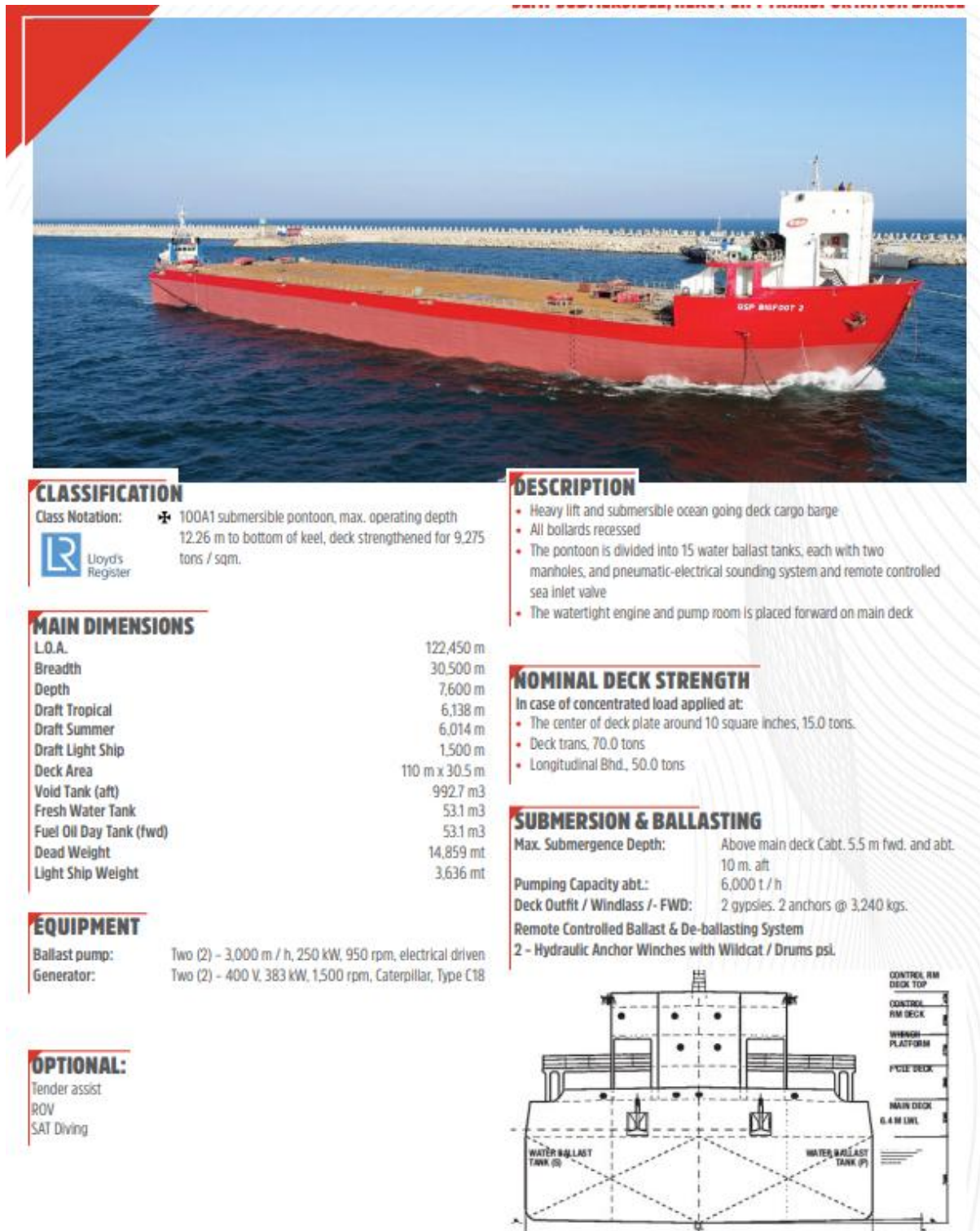
Πίνακας 3-22: Τεχνικά χαρακτηριστικά της πλωτής φορηγίδα μεταφοράς φορτίου, σύμφωνα με το τεχνικό φυλλάδιο της
