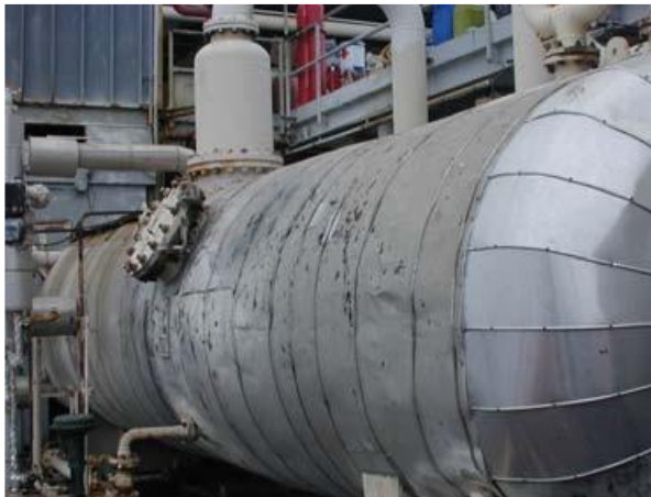
Σχήμα 2-11: Απελαιωτής M-111
