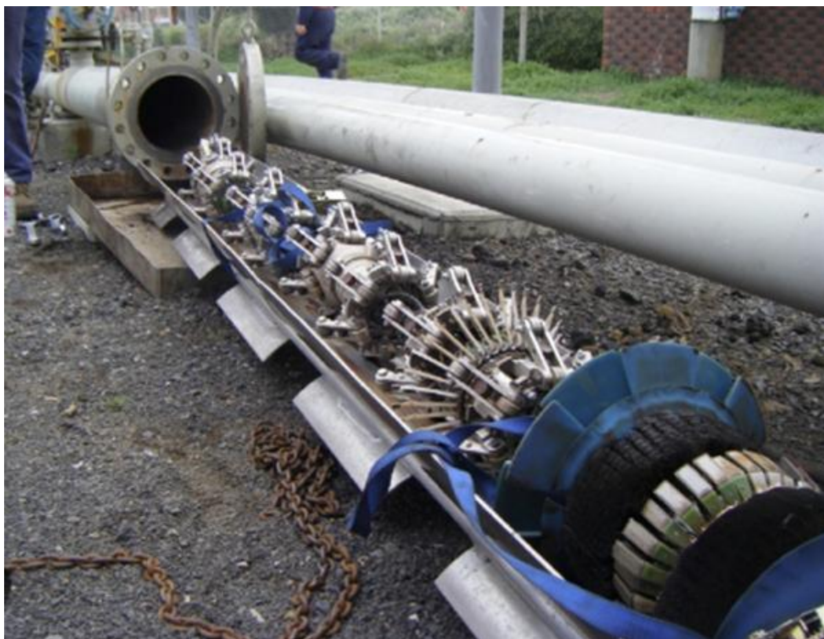
Σχήμα 3-32: Εξοπλισμός ελέγχου αγωγού (Intelligent pig)
