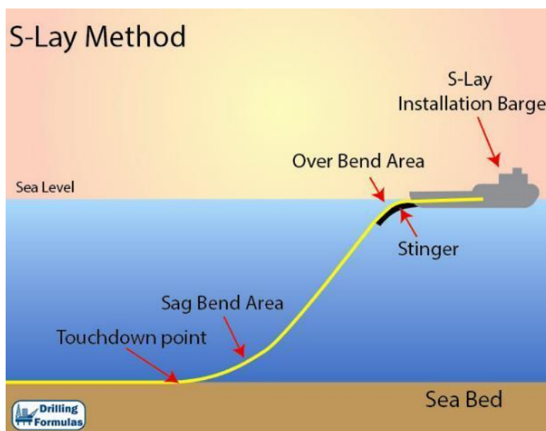
Σχήμα 2-44: Σχηματική απεικόνιση μεθόδου S-Lay
