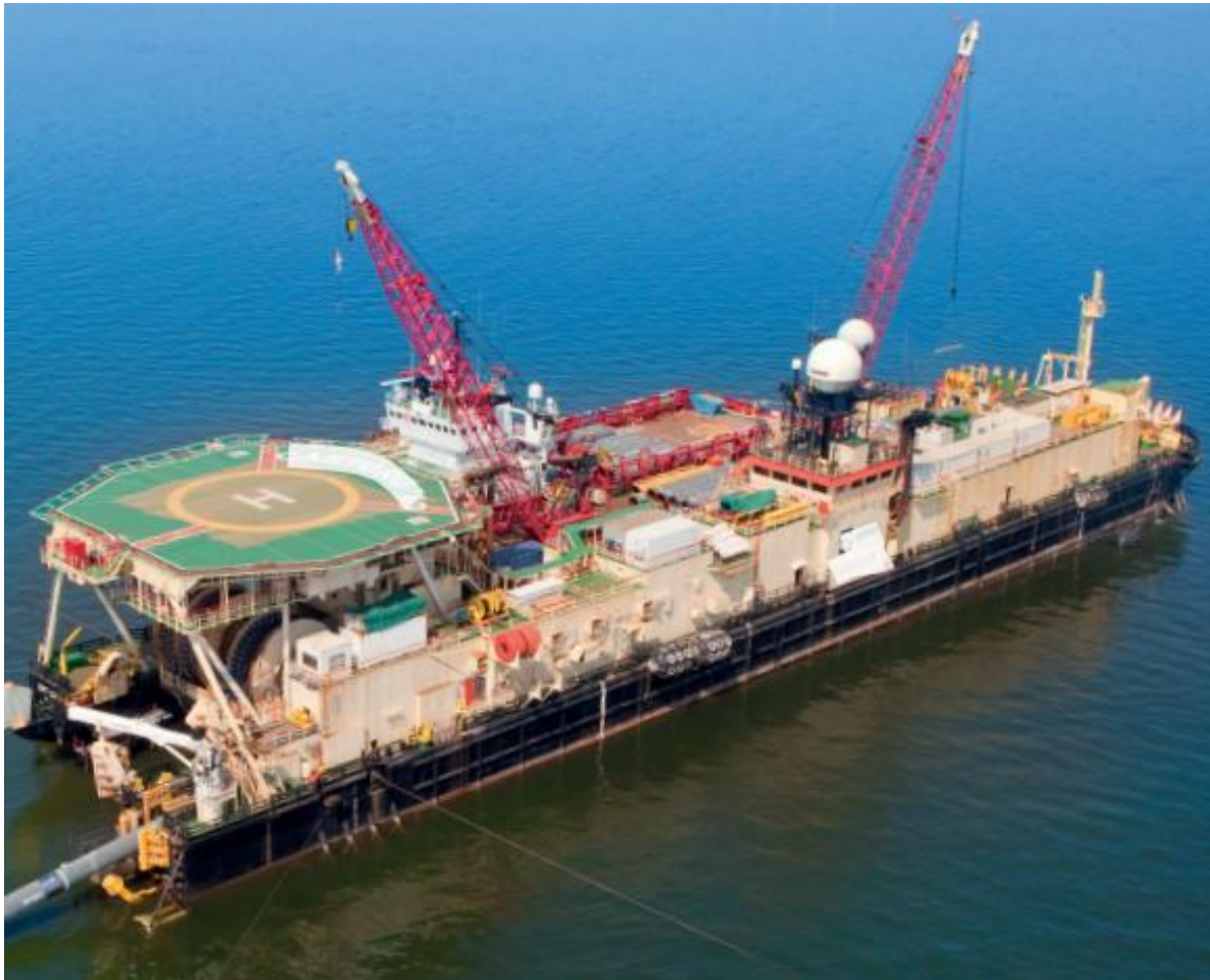
Σχήμα 3-30: Τυπικό πλοίο κατασκευής του αγωγού (pipelay and trenching vessel)
