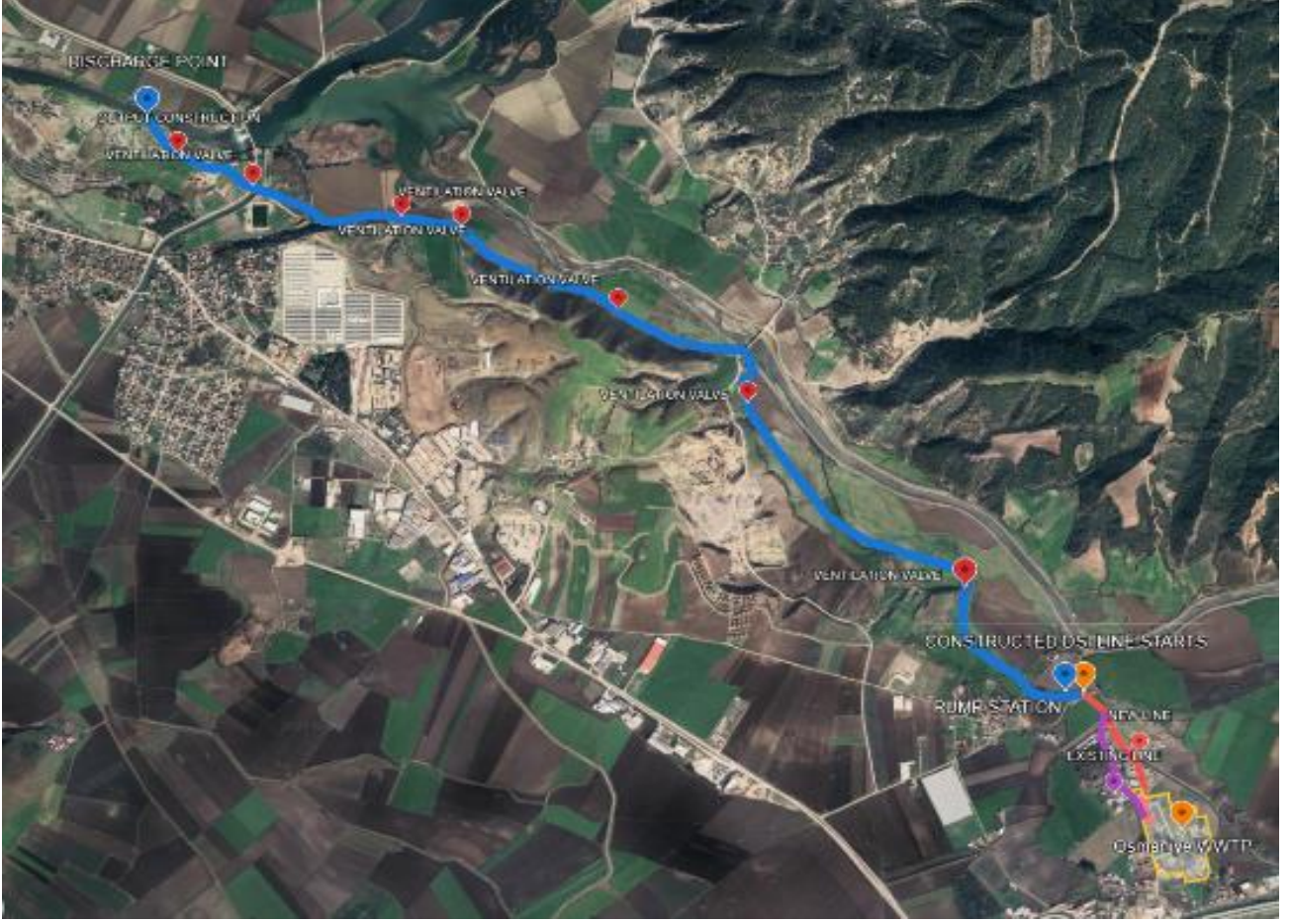
Şekil -22 Mevcut atık su tahliye borusu (ilk kısım pembe, ikinci kısım mavi ile işaretlenmiştir)
