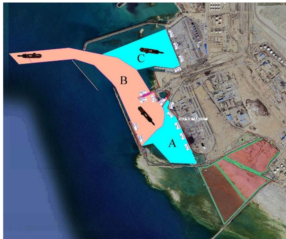
Б-сурет: Байланысты тереңдету жобасы (Теңіз түбінен алынған материалмен толтырылатын аймақтар қызыл түспен көрсетілген.)
