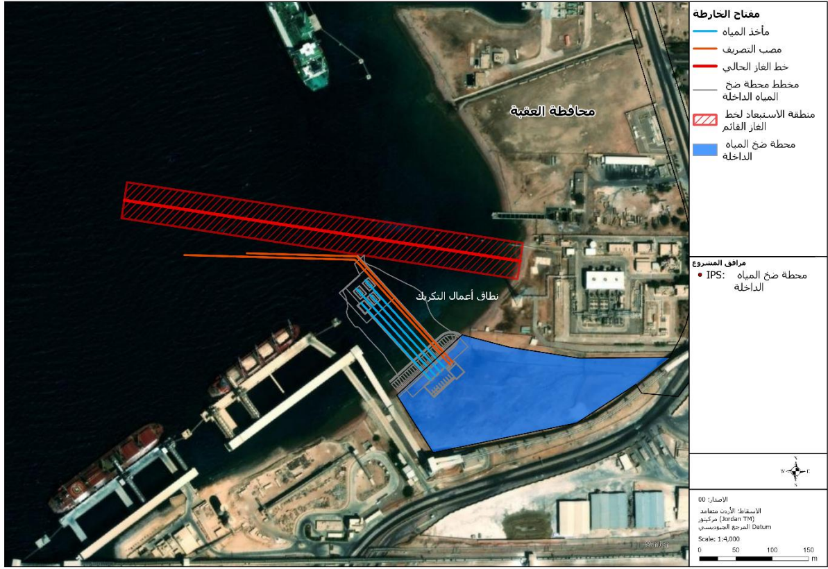
الشكل 14 مخطط تخطيطي إرشادي لمنشآت السحب والتصريف البحري ومحطة ضخ السحب
