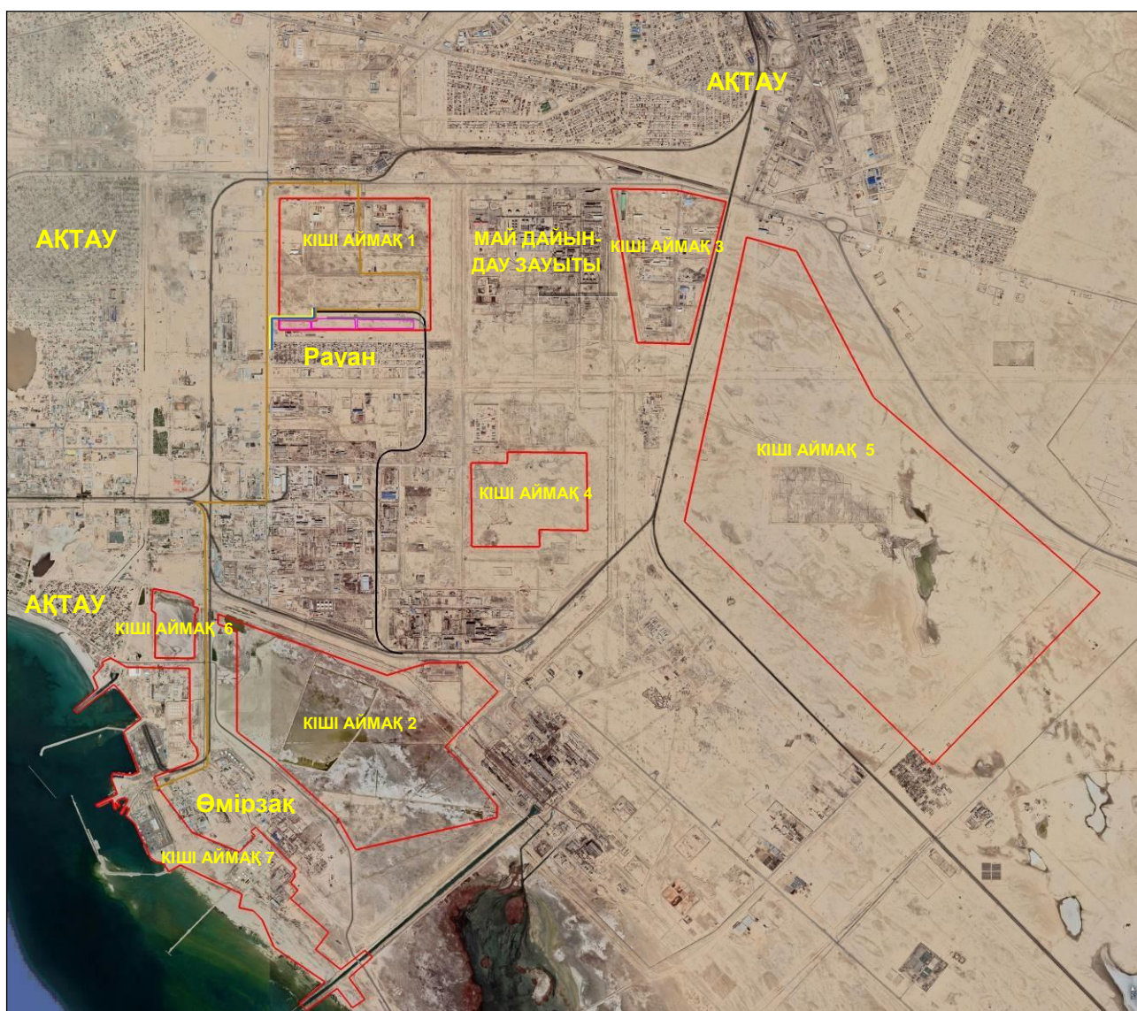
Сурет 1 Спутниктік суретте (2018 ж. шілде) арнайы экономикалық аймақтың 1-7 ішкі аймағының айналасындағы аумақтар (қызыл контурлар) және 1 ішкі инженерлік коммуникациялық аймақтар: 4-5 блоктар (күлгін квадраттар); қолданыстағы теміржол тармағы (қара); жоспарланған тармақ (сұр); портқа жол (қызыл); газ құбыры (сары) және су құбыры (көк) көрсетілген.
