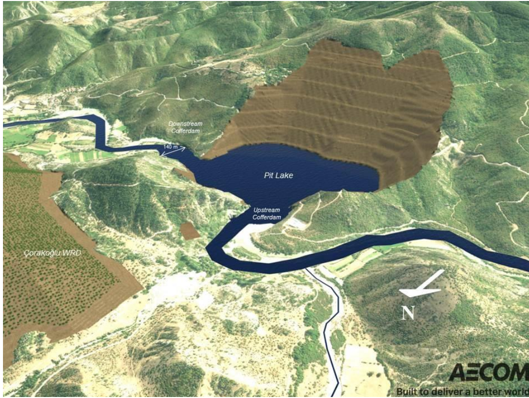
Şekil 5-3 Açık Ocağın Gökırmak Nehri İle Taşması İçin Kavramsal Kapatma Senaryosu
