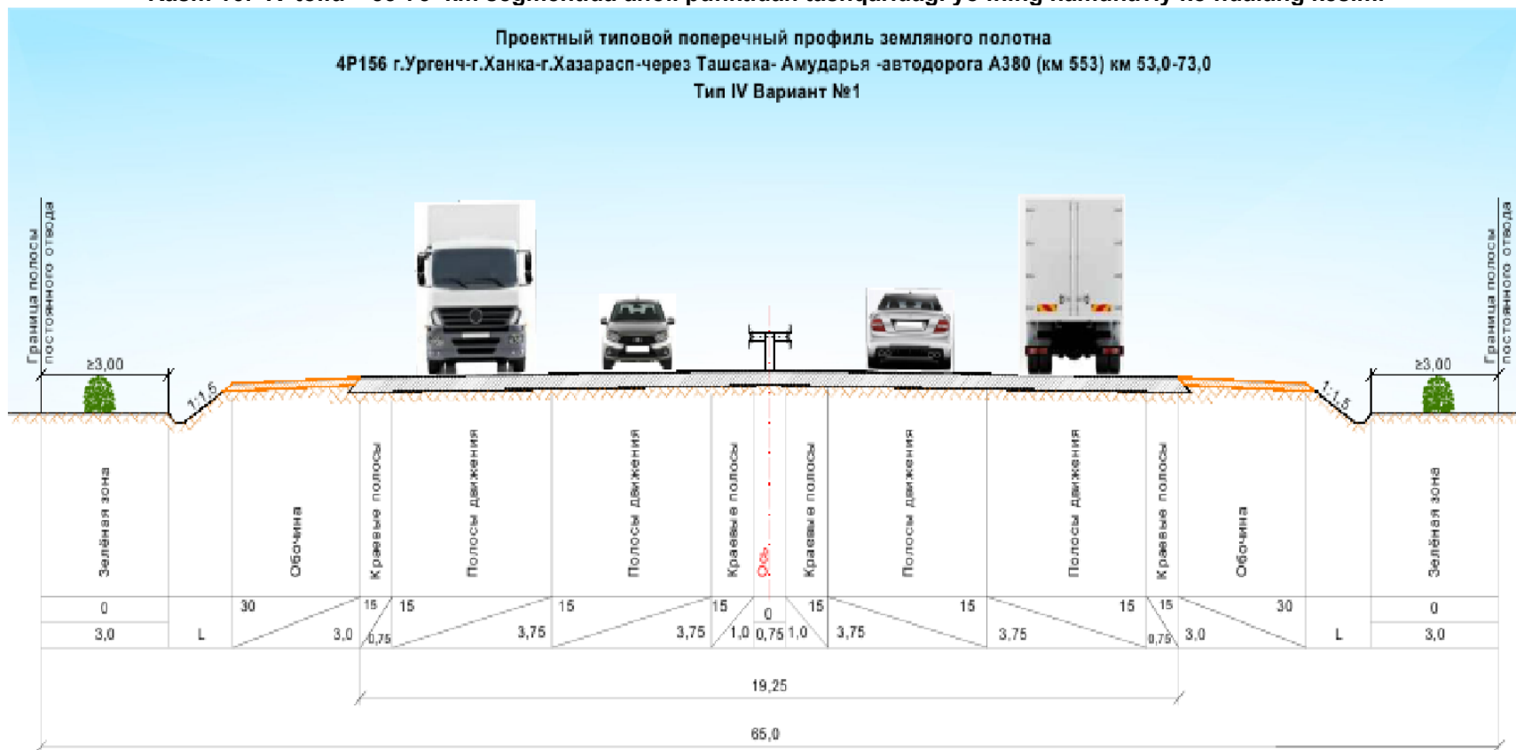
Rasm 16: IV toifa – 53-73 km segmentida aholi punktidan tashqaridagi yo‘lning namunaviy ko‘ndalang kesimi
