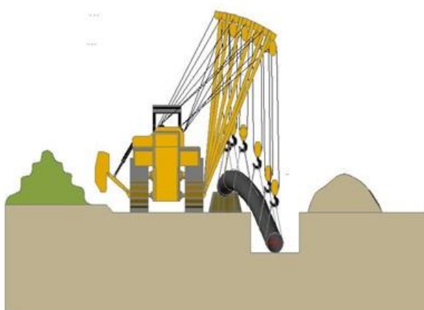
Figura 4.4 Vedere schematică a amplasării conductelor de transport gaz
