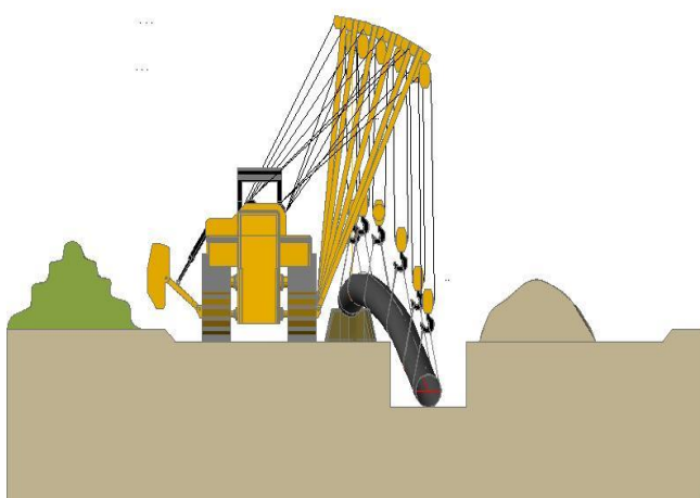
Fig. 1.IX. Etapa de lansare a conductei de transport gaze naturale schematic (stânga) și aspect de la nivelul unui șantier (dreapta)
