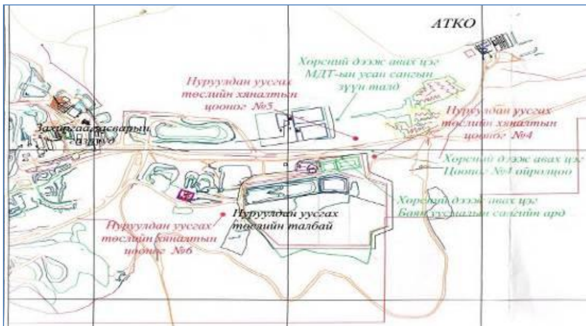
Зураг 31. Нуруулдан уусган төслийн хаягдлын сан, хяналтын цооногуудын байршил
