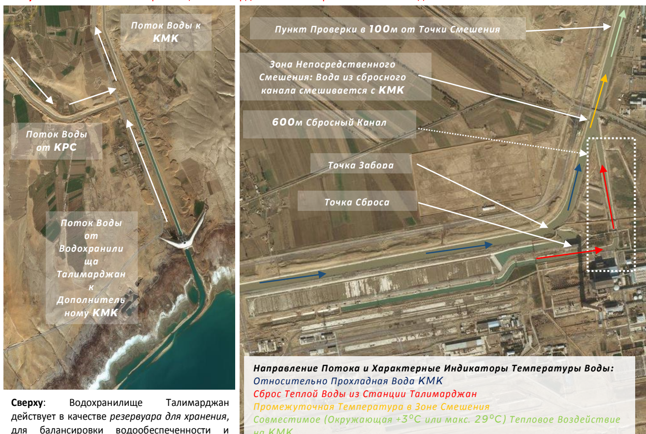
Рисунок 4: КМК и Теплоэлектростанция Талимарджан Система Прямоточного Охлаждения
