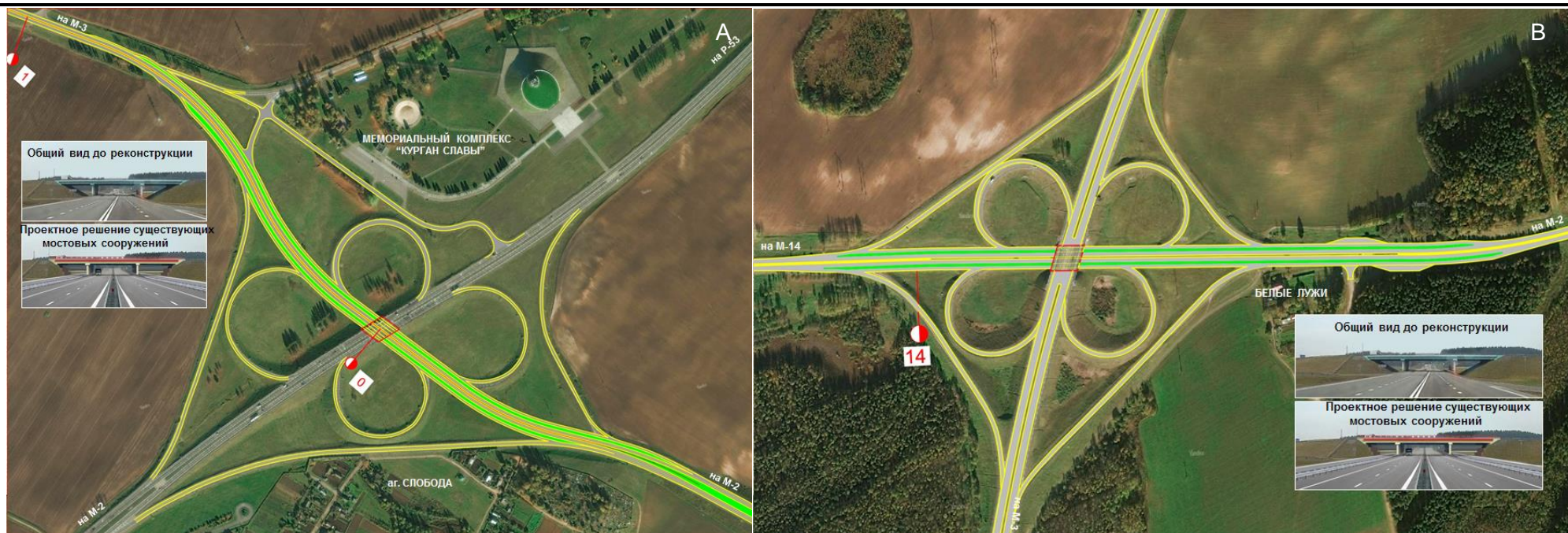
Рисунок 2.3-2 Схемы реконструкции транспортных развязок (А) на пересечении с автомобильной дорогой М-2 и (В) на пересечении с автомобильной дорогой М-3
