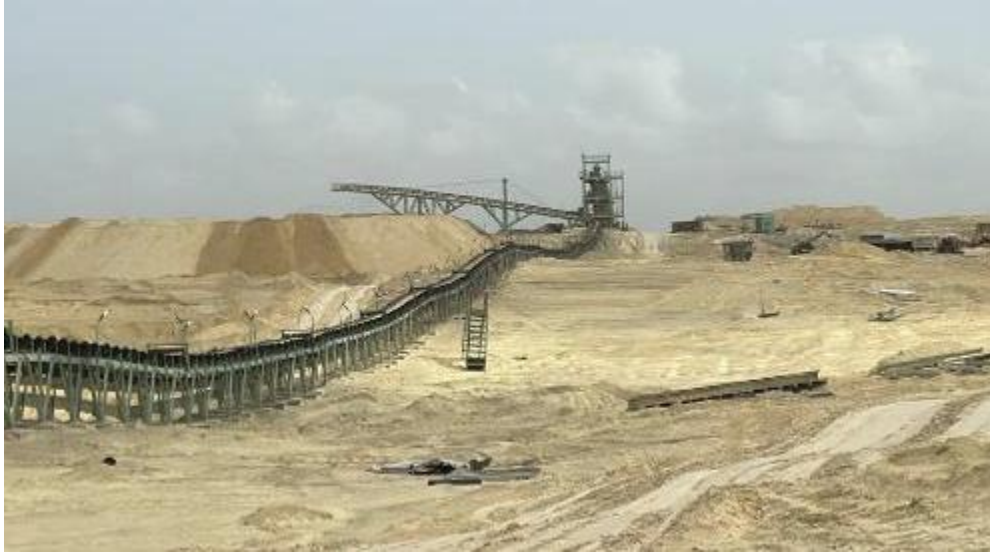
الشكل رقم (١٧-١): صورة نمطية للسير الناقل للجبس الفوسفاتي
